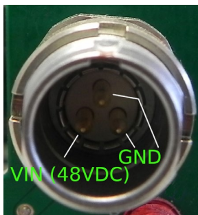
Abb. 3: Stromanschluss 48 V DC – Pin-Belegung
