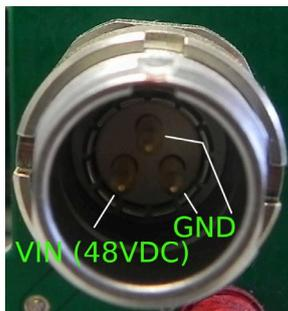
Abb. 3: Stromanschluss 48 V DC – Pin-Belegung
