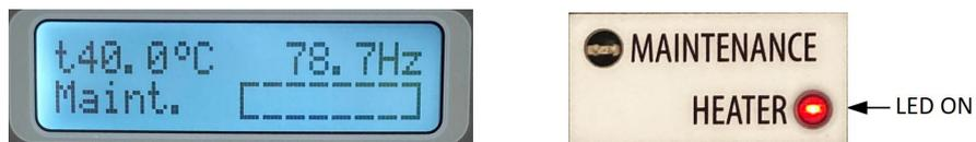
Abb. 13: Display und Heizungs-Kontrollleuchte, wenn die Solltemperatur stabil ist
