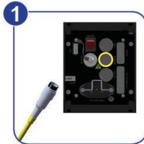
Abb. 25: Sensorkabel anschließen – Schritt 1
