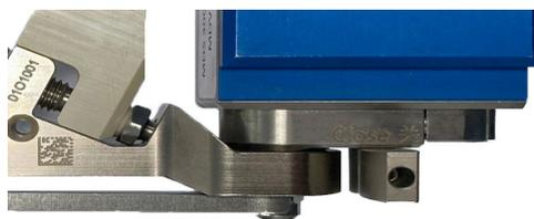
Abb. 35: Einschrauben der Düsenfixiermutter
