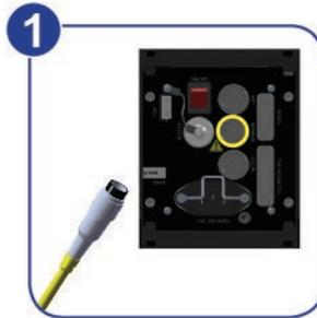
Abb. 25: Sensorkabel anschließen – Schritt 1
