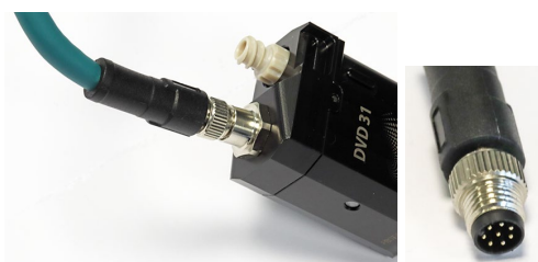
Abb. 19: Sensor-Bus-Kabel in den DVD eingesteckt (und M8-Stecker)
