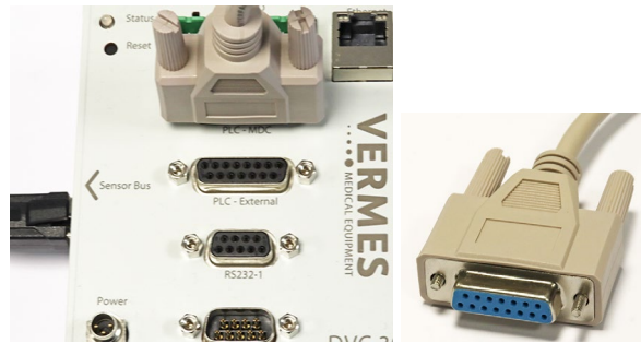
Abb. 20: SPS-Verbindung zur MDC (und weiblicher 15-poliger Sub-D-Stecker)
