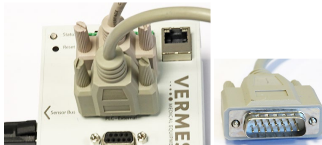
Abb. 21: SPS-Verbindung zur SPS/Maschine (und männlicher 15-poliger Sub-D-Stecker)
