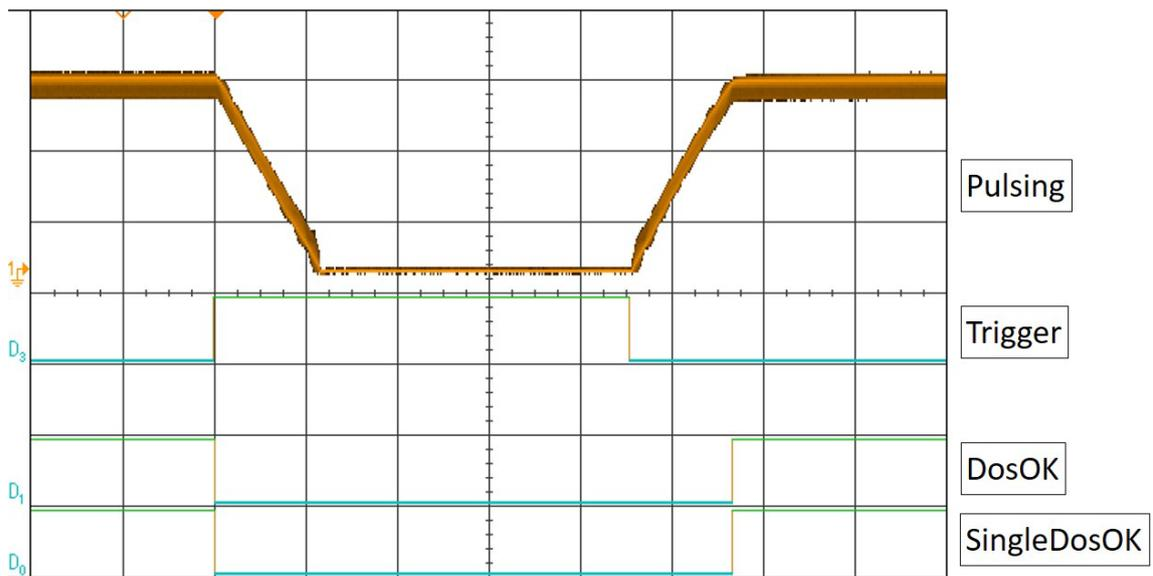
Fig. 66: Infinite Mode
