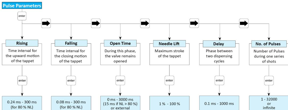
Fig. 7: Submenu „Pulse Parameters“
