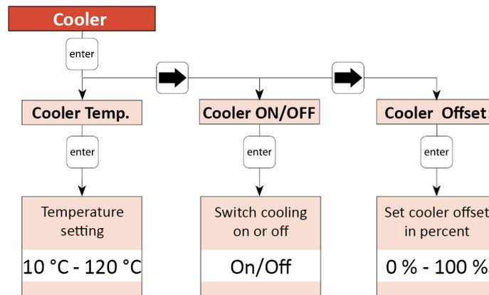
Fig. 60: Submenu Cooler
