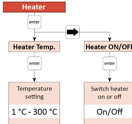
Fig. 11: Submenu “Heater”
