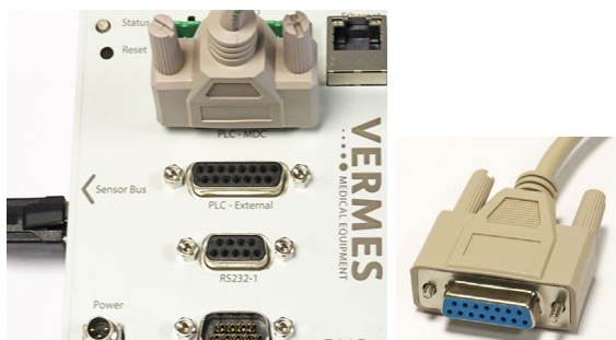
图 20: MDC与DVC的PLC连接（和15-pin SUB-D母接头）
