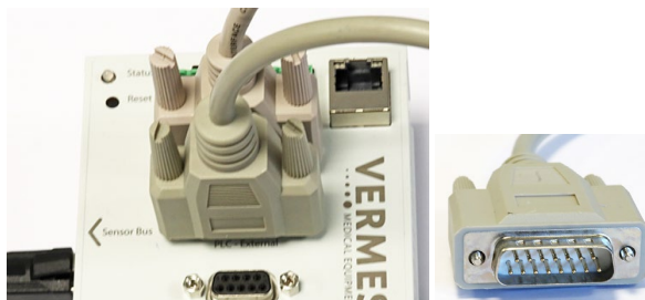
图 21: 用户电脑/机器与DVC的PLC连接 (和15-pin SUB-D公接头)
