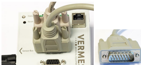
图 21: 用户电脑/机器与DVC的PLC连接 (和15-pin SUB-D公接头)
